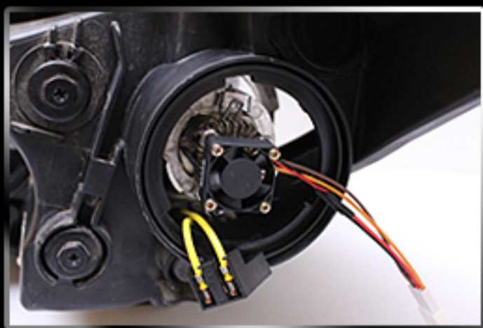
5. Установите лампу и зафиксируйте ее штатными скобами-держателями
